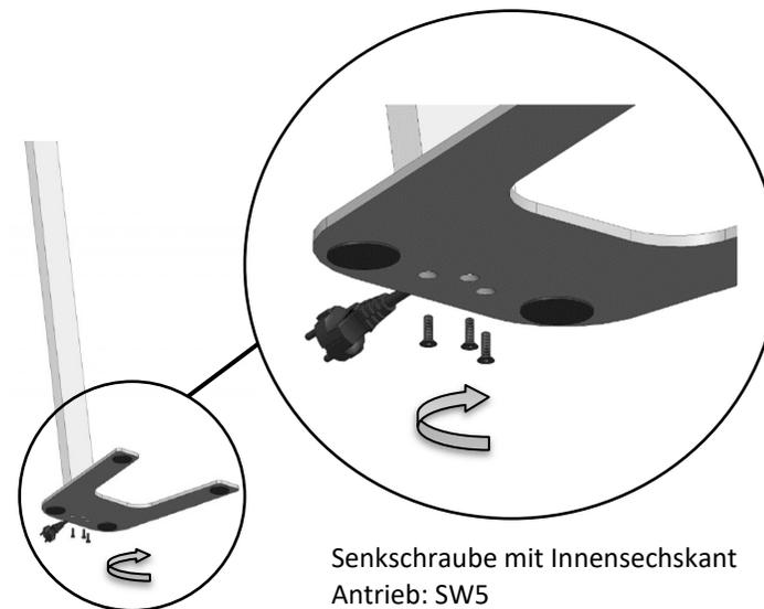
Fuß mit Standrohr verschrauben.
